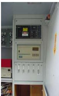
**Figura 6.24 – Analisadores dos gases de exaustão da microturbina**
