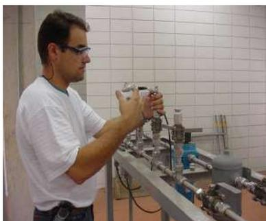
**Figura 6.20 – Coleta de amostra do gás para análise da concentração de  $\text{H}_2\text{S}$  presente no biogás**
