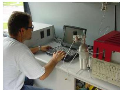
**Figura 6.22 – Os dados são enviados ao computador que calcula as concentrações de cada um dos componentes encontrados na mistura**
