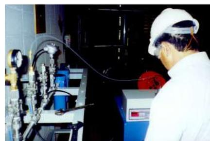
**Figura 6.19 – Procedimento de análise da umidade presente no biogás pelo método do Ponto de Orvalho (P.O.)**
