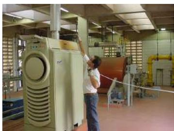
**Figura 6.26 – Coleta de amostra dos gases de exaustão da microturbina**
