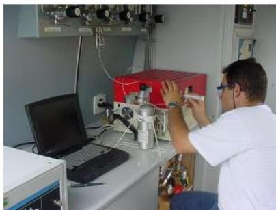
**Figura 6.21 – Amostra sendo injetada em um Cromatógrafo Gasoso para determinação da concentração de  $\text{H}_2\text{S}$  presente no biogás**
